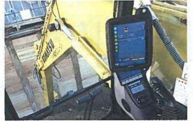
確認作業などを大幅に削減したICT対応の重機
